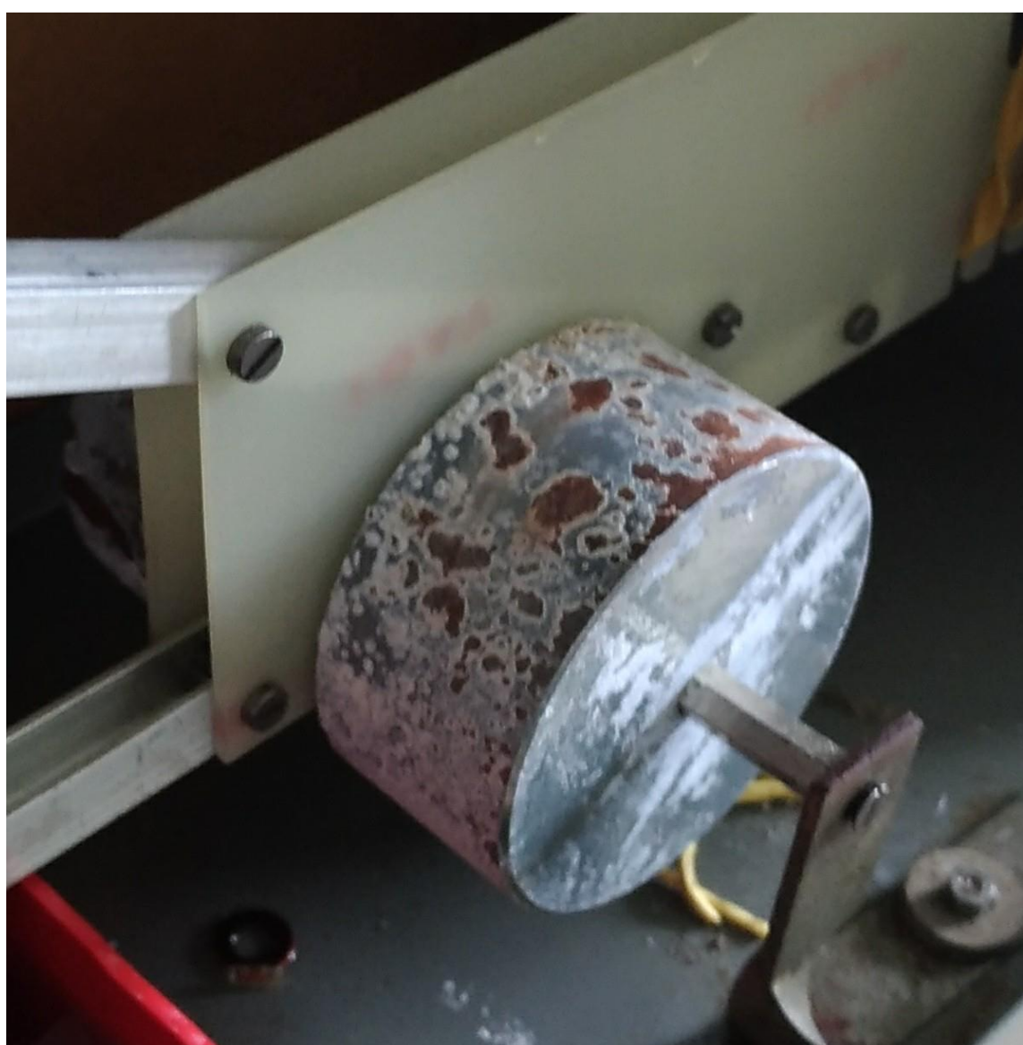
Massa usurata del vecchio sismometro
