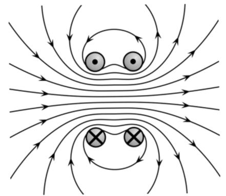
Data la geometria del sistema, le linee di campo saranno disposte come in figura, generando un campo magnetico uniforme nella zona compresa tra le due bobine.
