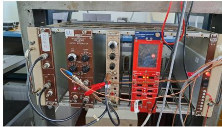
Figura 2.12: La catena elettronica. Il modulo di alta tensione (a destra), gli amplificatori (al centro) e l'ADC (a sinistra)
