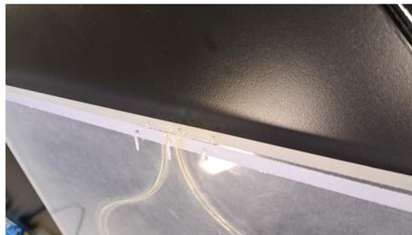
Figura 2.2: Dettaglio dei terminali della fibra ottica dello scintillatore
