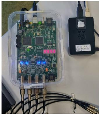
Figura 2.3: Scheda Fermilab per la rilevazione delle coincidenze e Raspberry Pi 3 per l'acquisizione dati e loro salvataggio
