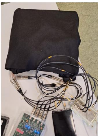
Figura 2.5: Piastre accoppiate con un ulteriore involucro di stoffa per la tenuta della luce, con visibile la componente elettronica (Fermilab e Raspberry)
