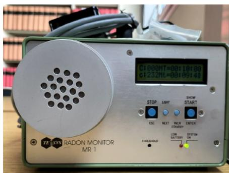
Figura 2.7: Rivelatore radon dell'ARPAV, dove si vede la cella di Lucas montata con la membrana rivolta verso l'esterno
