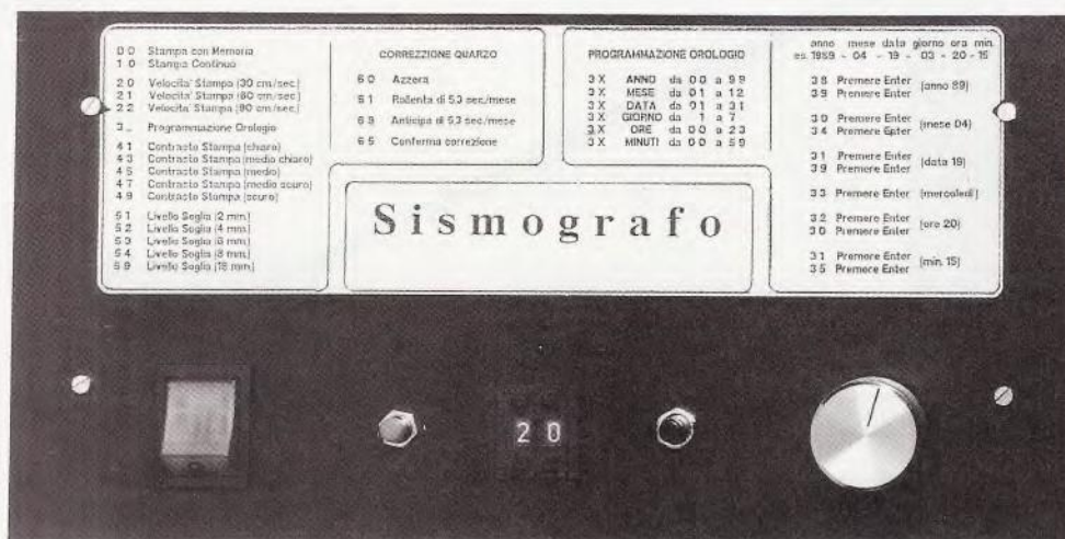
Fig.35 Sul pannello frontale del mobile che fisserete sulla tavoletta in legno (vedi fig.40), troveranno posto l'interruttore completo di una lampadina al neon, il doppio commutatore binario, i due pulsanti ed il potenziometro della sensibilità. Le scritte riportate sul pannello di questa foto sono provvisorie, su quello definitivo risulteranno diverse e più complete.
