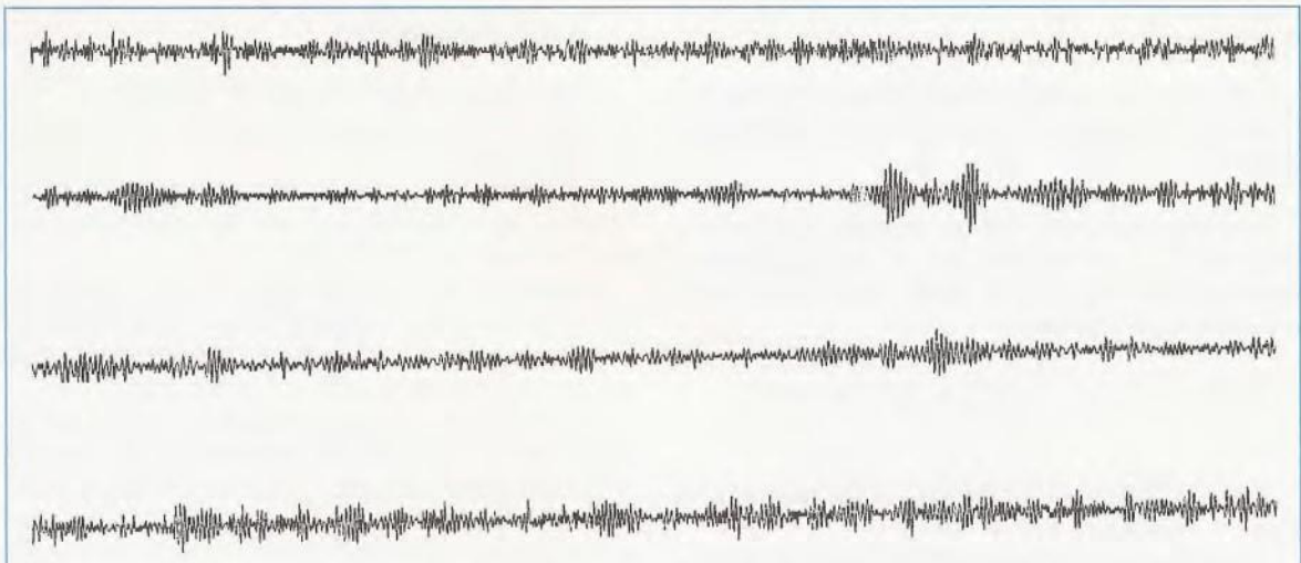
Fig.3 La sensibilità di questo sismografo è così elevata da permettere di rilevare anche le più microscopiche vibrazioni della terra. Perciò anche predisponendolo per una sensibilità media, sulla carta non vedremo mai una linea perfettamente rettilinea, ma tanti sciami di oscillazioni provocate normalmente da variazioni della pressione atmosferica, da mareggiate, frane, esplosioni di mine, assestamenti del sottosuolo, ecc.
