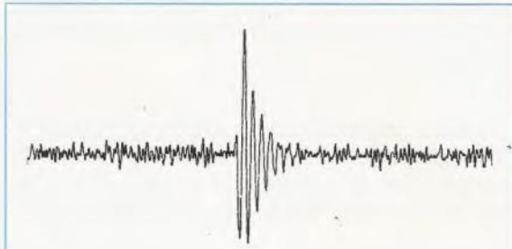
Fig.1 Le onde sismiche provocano delle vibrazioni a bassissima frequenza. Infatti, per completare una sinusoide occorrono in media da 3 a 20 secondi, perciò in un tempo di "1 minuto" verranno tracciate sulla carta dalle 3 alle 20 sinusoidi al massimo. Nel disegno un'oscillazione da noi provocata artificialmente.
